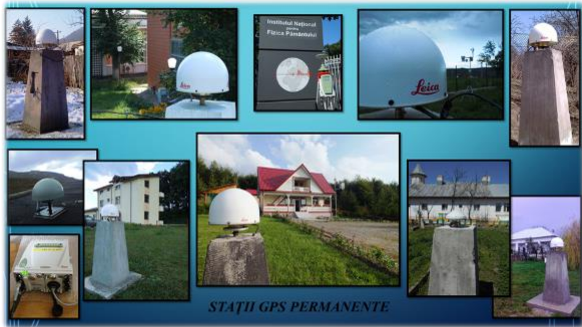
Echipamente GPS instalate la stațiile RSN
