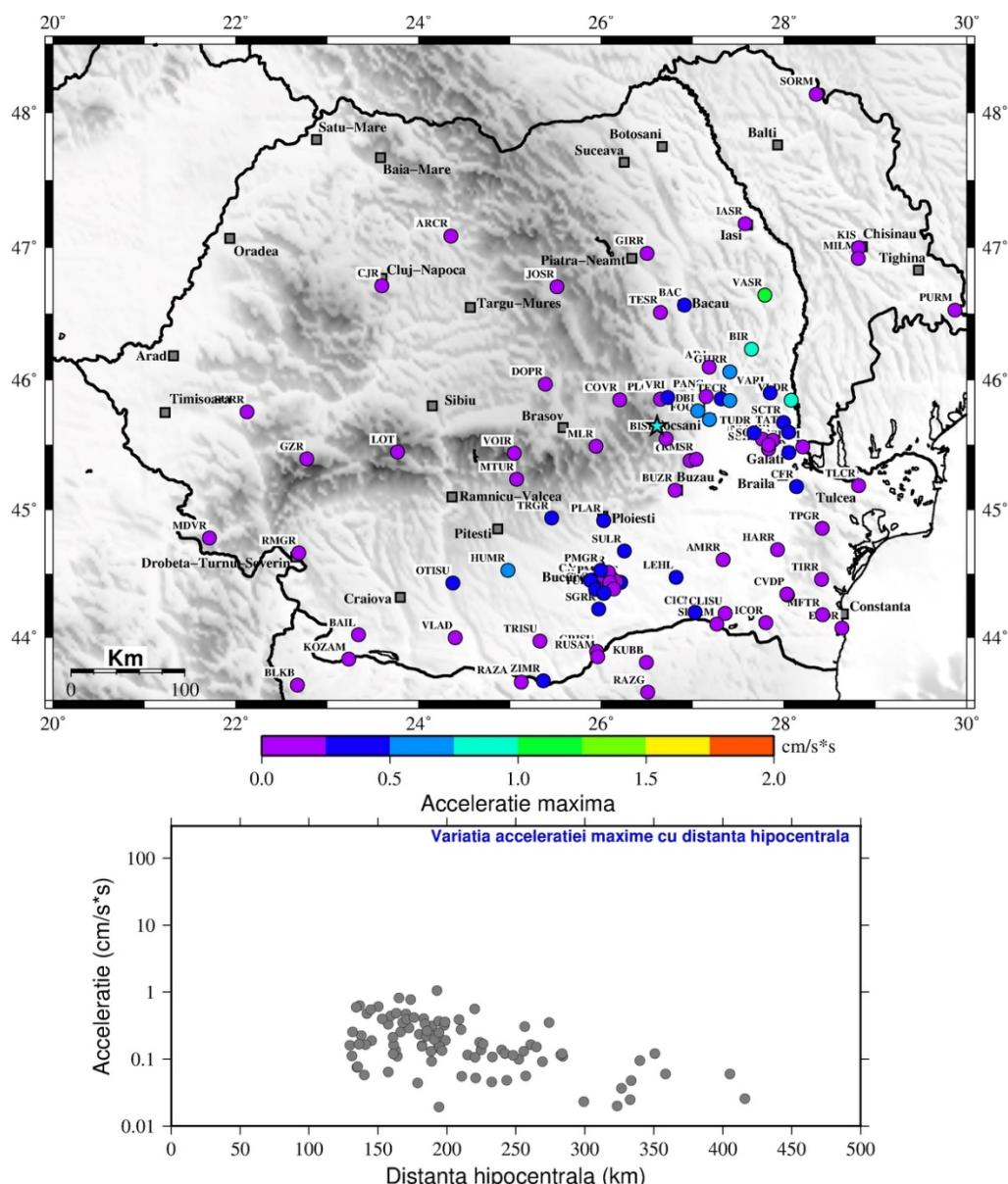
**Harta cu accelerăriile solului înregistrate de Rețeaua Seismică Națională (maximul accelerării de pe componentele orizontale NS, EV) și variația accelerării maxime cu distanța hipocentrală**
