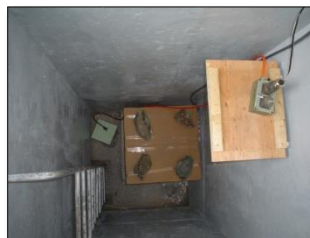
Senzorii seismici de bandă largă și de accelerație
