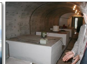
Senzorii seismici instalați în tunel
